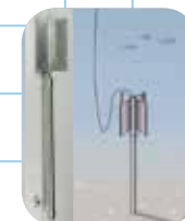
重力式取樣管鑽探海床
